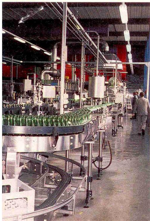
**In dieser nach dem modernsten Stand der Technik arbeitenden vollautomatischen Anlage werden bis 6'000 Flaschen pro Stunde luftfrei und schonend mit Wein oder Traubensaft-Spezialitäten abgefüllt.**
